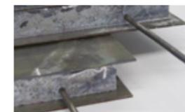
Stahl-Aluminiumschaum-Sandwiches mit Stahlrohr
